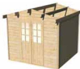
5 Vorgefertigte Dachkonstruktion ausrichten und fixieren
