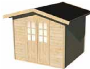
6 Zum Abschluss werden Dachplatten und Dachpappe montiert. Fertig!
